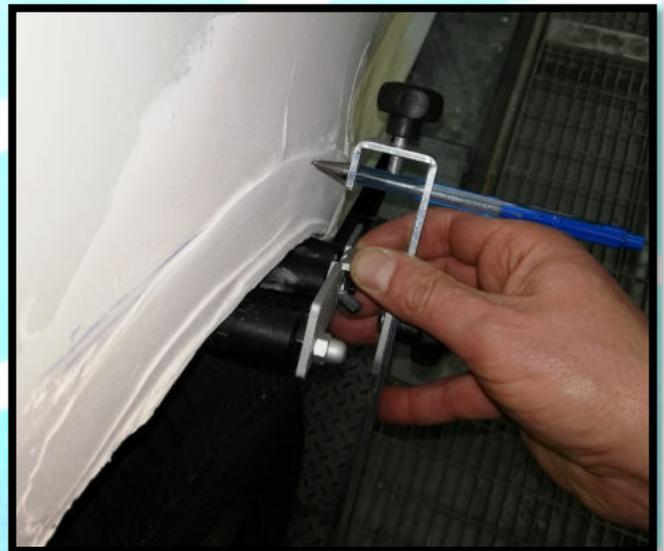
IL TRACCIATORE PER LINEE PARAFANGO, GRAZIE AL PISTONCINO GUIDA CENTRALE, ROTANTE E REGOLABILE IN ALTEZZA, SI ADATTA PIU' FACILMENTE A QUALSIASI ANGOLO DI CURVATURA E PERMETTE DI TRACCIARE UNA LINEA CONTINUA E PRECISA DA BORDO A BORDO; ESSENDO INFATTI IN ASSE CON IL MARKER, GARANTISCE UN PUNTO D'APPOGGIO PRECISO DAL SOTTOPORTA FINO AL PARAURTI.
