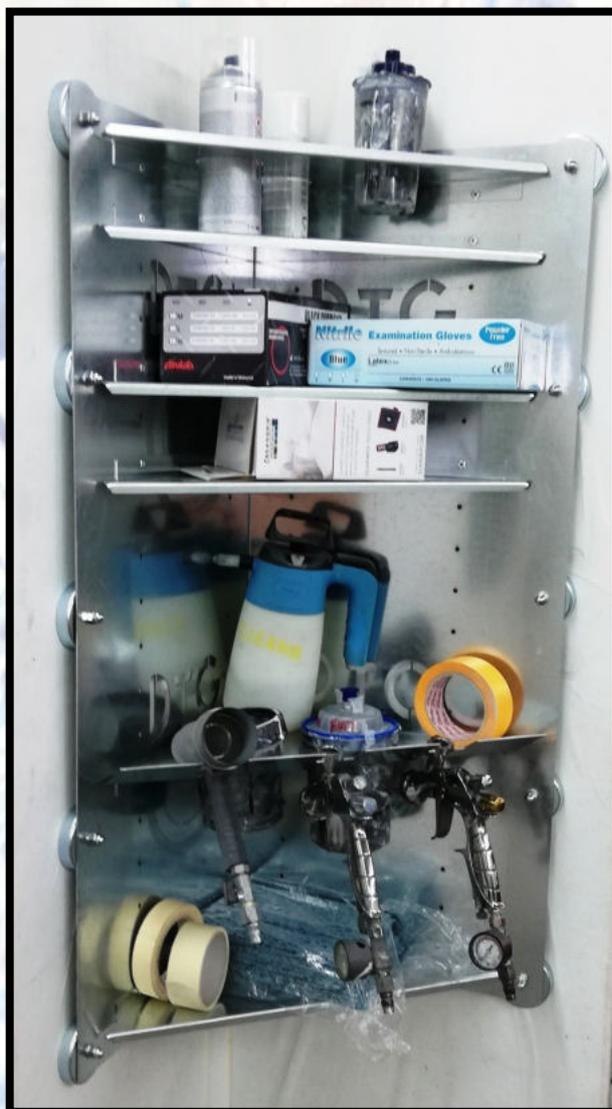
SOLUZIONE AD ANGOLO, NATA PER RISPONDERE ALLE ESIGENZE DI CHI VUOLE DISPORRE DI TUTTO IL NECESSARIO PER LA VERNICIATURA (MATERIALE E ATTREZZATURA) IN UN UNICO POSTO E A PORTATA DI MANO, IN MANIERA ORGANIZZATA E ALL'INTERNO DEL FORNO. I SUOI DODICI POTENTI MAGNETI GARANTISCONO TENUTA E STABILITA'
